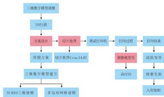
图 6 紫砂壶 3D 打印流程图
